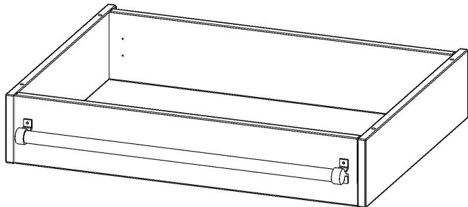
Bei einer Leiterzarge handelt es sich um ein Zwischenstück, welches ähnlich wie ein Sockel gebaut wird. Die Höhe der Leiterzarge beträgt 15 cm. An der Zarge wird ein Aluminiumrohr mittels entsprechenden Halterungen so montiert, dass die jeweils passenden Einhängeleitern sicher eingehängt werden können.
