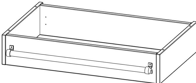
Bei einer Leiterzarge handelt es sich um ein Zwischenstück, welches ähnlich wie ein Sockel gebaut wird. Die Höhe der Leiterzarge beträgt 15 cm. An der Zarge wird ein Aluminiumrohr mittels entsprechenden Halterungen so montiert, dass die jeweils passenden Einhängeleitern sicher eingehängt werden können.
