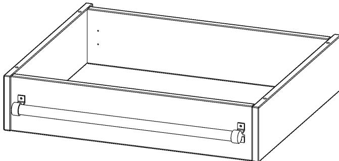
Bei einer Leiterzarge handelt es sich um ein Zwischenstück, welches ähnlich wie ein Sockel gebaut wird. Die Höhe der Leiterzarge beträgt 15 cm. An der Zarge wird ein Aluminiumrohr mittels entsprechenden Halterungen so montiert, dass die jeweils passenden Einhängeleitern sicher eingehängt werden können.
